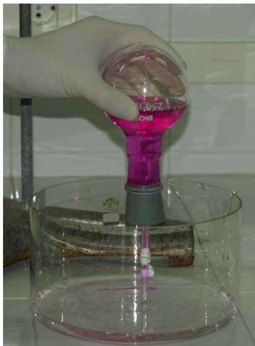
Figura 6. Reacción de la fenolftaleína con amoníaco
