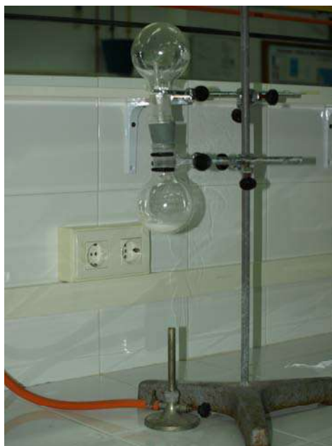
Figura 4. Producción de amoníaco gas
